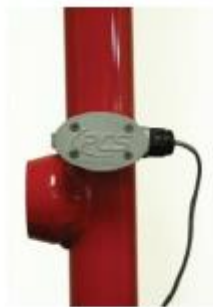
Slika 3-4. Položaj magnetskog davača impulsa na ušću bušotine (Tehnička dokumentacija INA d.d., 2015)
