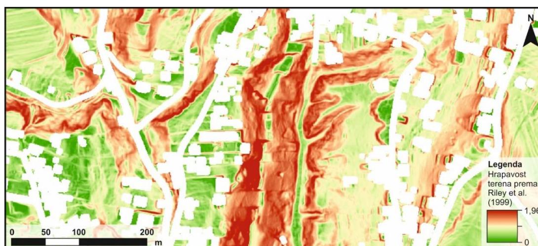
Slika 5.21 Morfometrijska karta hrapavosti terena dijela pilot područja u podsljemenskoj zoni Grada Zagreba prema Riley et al. (1999) dobivena kvadratnim prozorom dimenzija 3x3 m.
