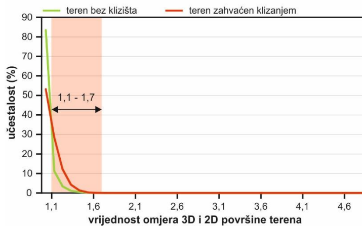
Slika 7.33 Raspodjela učestalosti vrijednosti omjera 3D i 2D površine terena na terenu bez klizišta i terenu zahvaćenom klizanjem.
