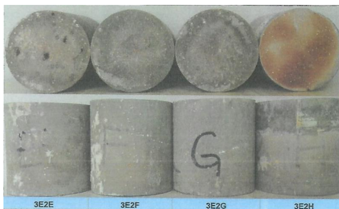
Slika 4-27. Uzorak cementnog kamena dobiven očvršćavanjem cementne kaše 3E2 nakon izlaganja vodenoj kupki zasićenoj s ugljikovim dioksidom
