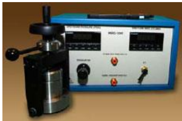
Slika 4-4. Plinski permeametar tvrtke Core Laboratories (CoreLab, 2019)
