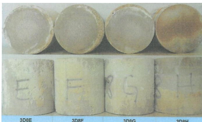
Slika 4-26. Uzorak cementnog kamena dobiven očvršćavanjem cementne kaše 3D8 nakon izlaganja vodenoj kupki zasićenoj s ugljikovim dioksidom
