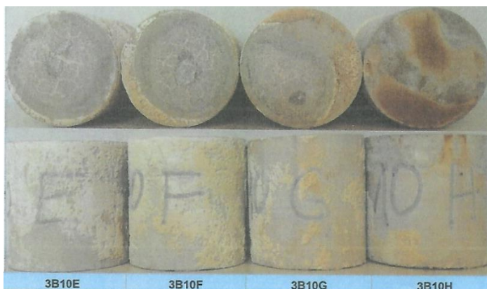
Slika 4-25. Uzorak cementnog kamena dobiven očvršćavanjem cementne kaše 3B10 nakon izlaganja vodenoj kupki zasićenoj s ugljikovim dioksidom
