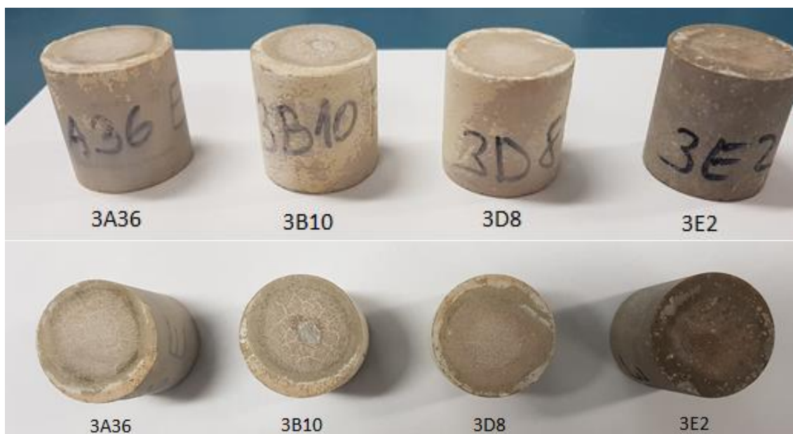
Slika 4-23. Uzorci cementnog kamena nakon izlaganja vodenoj kupki zasićenoj s ugljikovim dioksidom
