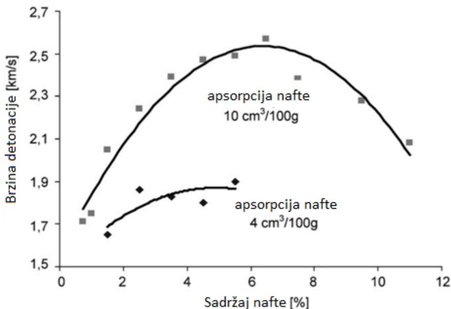
**Slika 4- 3.** Ovisnost brzine detonacije ANFO-a o apsorbiranoj nafti
