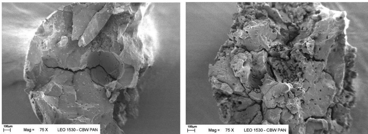
**Slika 4- 1.** Poprečni presjek neporozne kuglice amonijevog nitrata, korištene u poljoprivredi (lijevo) i porozne kuglice nakon apsorpcije nafte  $15 \text{ cm}^3/100 \text{ g}$  u nekoliko termalnih ciklusa (desno) (Zygmunt i Buczkowski, 2007)
