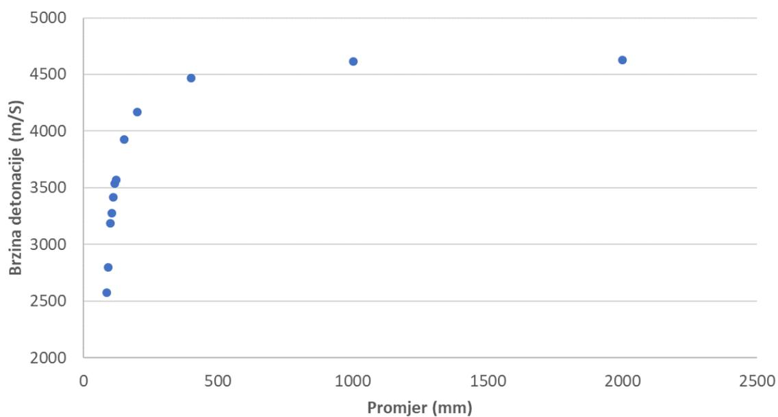
**Slika 4- 4.** Utjecaj promjera na proračunatu brzinu detonacije
