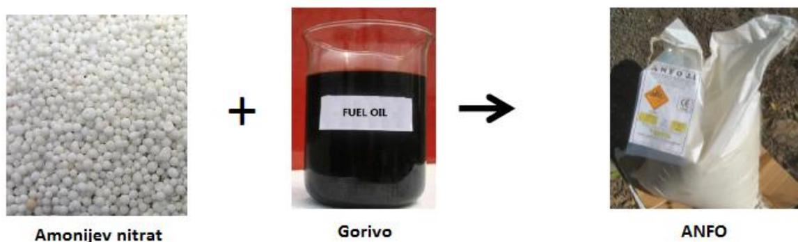
**Slika 3- 1.** Shematski prikaz proizvodnje ANFO eksploziva (Bohanek, 2016)
