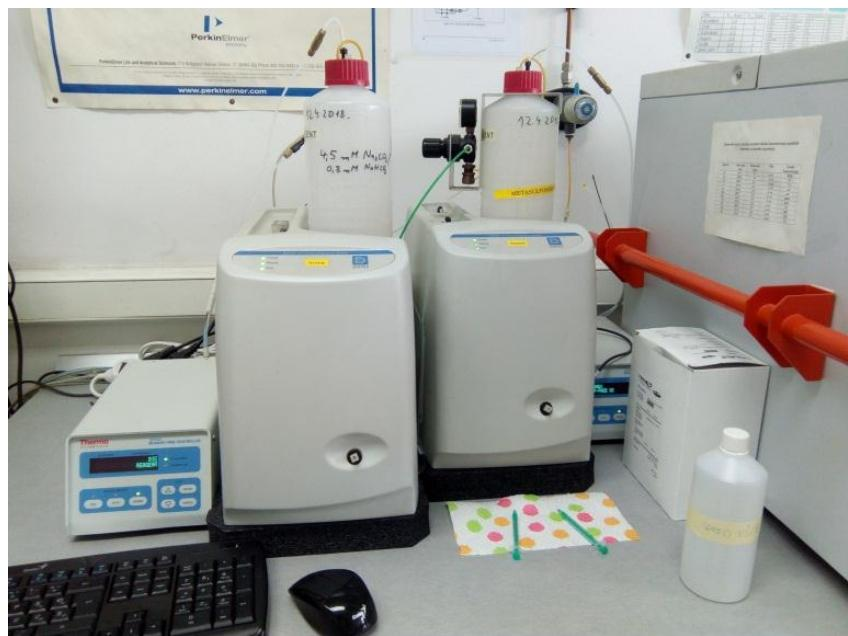
Slika 5.11. Ionski kromatograf ICS 90 tvrtke Dionex
