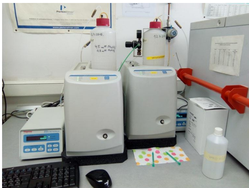
Slika 5.11. Ionski kromatograf ICS 90 tvrtke Dionex
