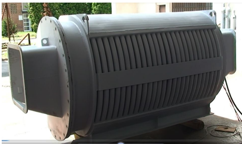
Slika 3-1 Uređaj zaštićen vrstom zaštite "d" tijekom pripreme za ispitivanje (Ex agencija, 2018)
