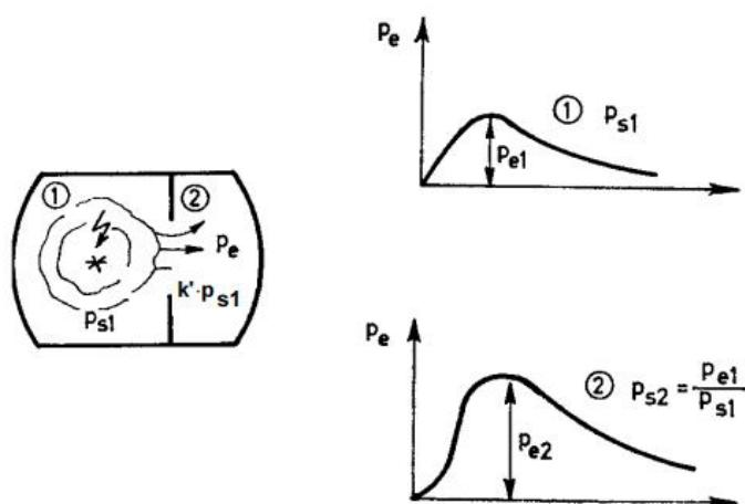
Slika 2-10 Povećanje tlaka eksplozije prekomprisijom u podijeljenom prostoru
