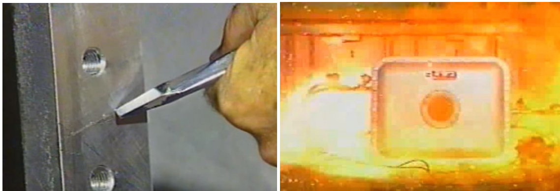
Slika 3-11 Utjecaj oštećenja raspora na probojno paljenje kućišta (Youtube, 2019)
