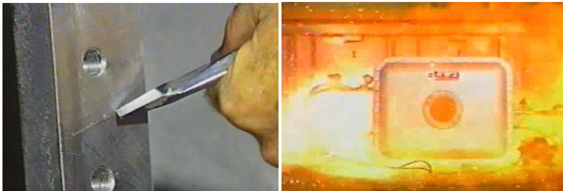
Slika 3-11 Utjecaj oštećenja raspora na probojno paljenje kućišta (Youtube, 2019)
