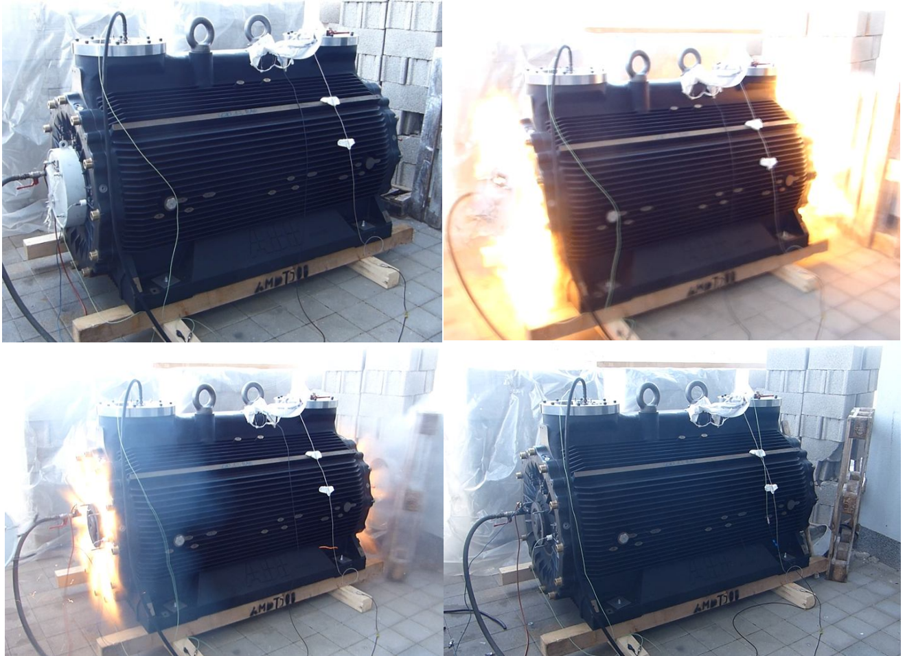
Slika 3-2 Isječci iz video snimke pri ispitivanju referentnog tlaka (Ex Agencija, 2018)
