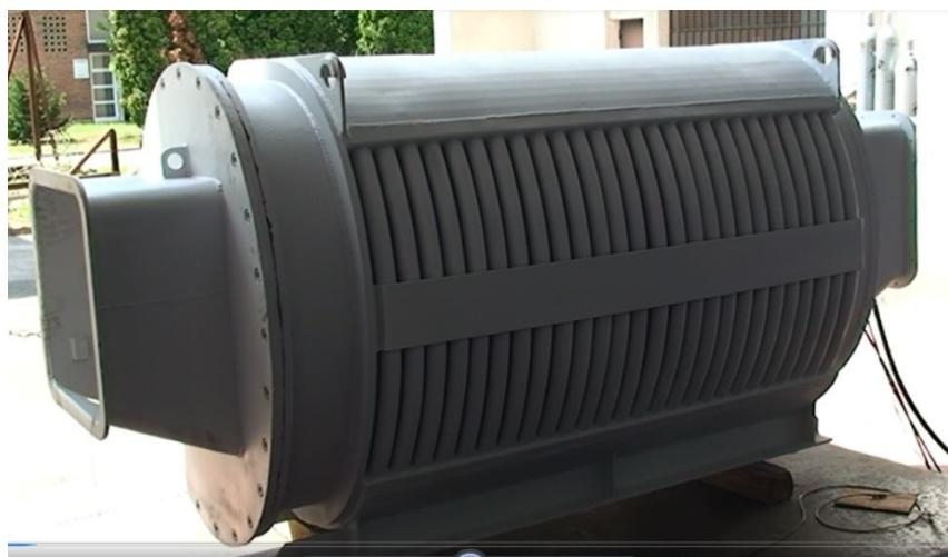
Slika 3-1 Uređaj zaštićen vrstom zaštite "d" tijekom pripreme za ispitivanje (Ex agencija, 2018)
