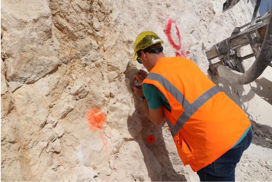
Slika 7.2 Konvencionalno inženjerskogeološko kartiranje diskontinuiteta na terenu geološkim kompasom. Orijentacija izmjerenog diskontinuiteta je 330/57.
