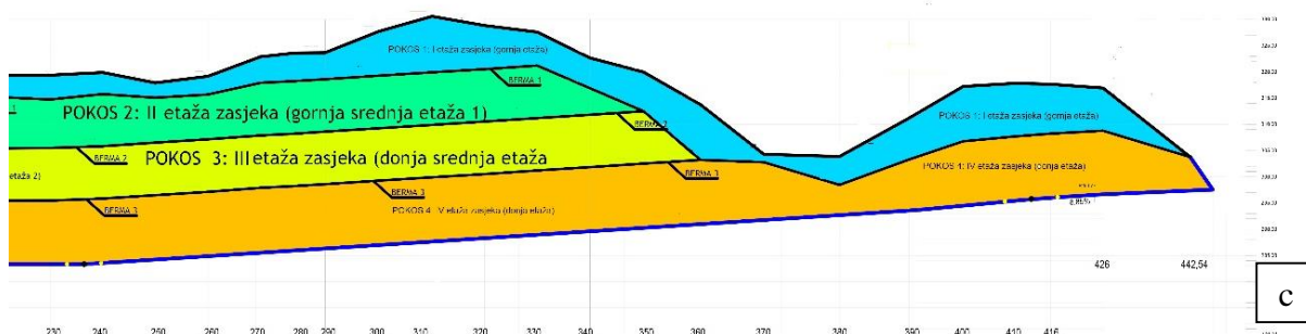
Slika 4.2 Tehnički prikaz pogleda na zasjek na stalnom graničnom prijelazu Gornji Brगत (Arbanas, 2019): (a) cijeli zasjek; (b) uvećani južni dio zasjeka; (c) uvećani sjeverni dio zasjeka).
