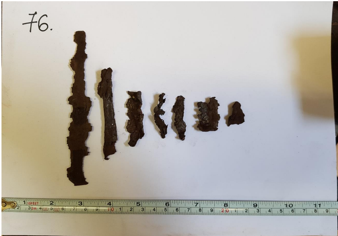
Slika 4-16. Krhotine cijevi broj 76 (90/75 \mu\text{m} , 5%)
