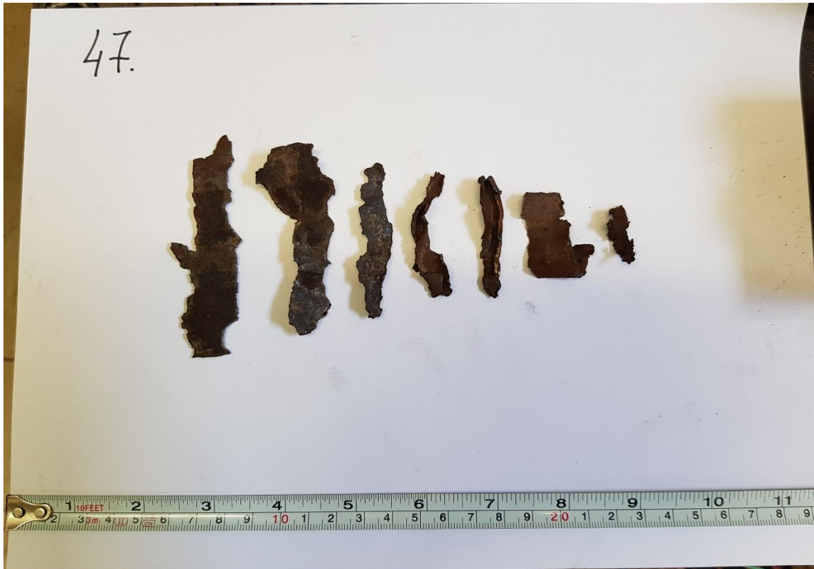
Slika 4-10. Krhotine cijevi broj 47 (63/45 \mu\text{m} , 4%)
