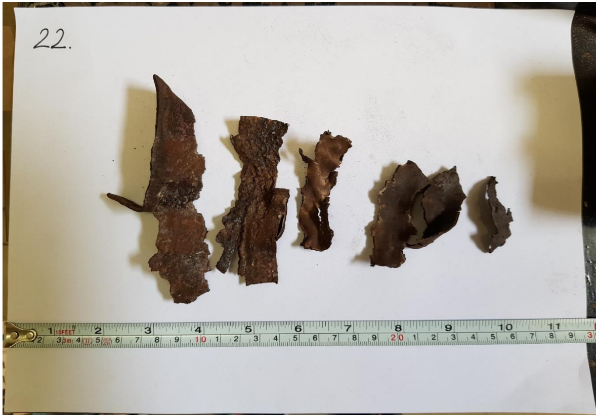
Slika 4-4. Krhotine cijevi broj 22 (-20 \mu\text{m} , 4%)
