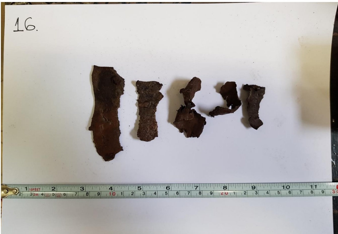
Slika 4-3. Krhotine cijevi broj 16 (-20 \mu\text{m} , 3%)
