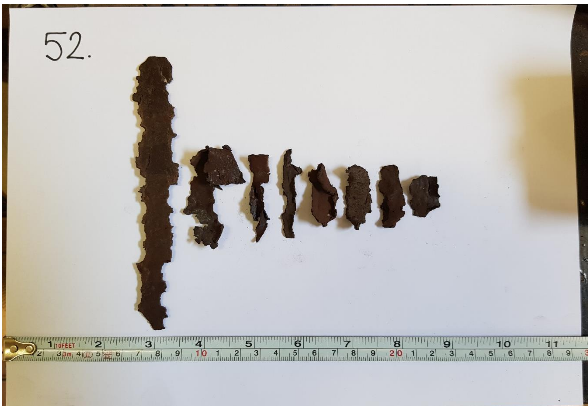
Slika 4-11. Krhotine cijevi broj 52 (63/45 \mu\text{m} , 5%)
