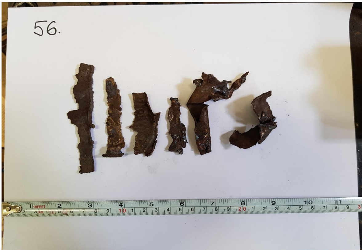
Slika 4-13. Krhotine cijevi broj 56 (90/75 \mu\text{m} , 1%)
