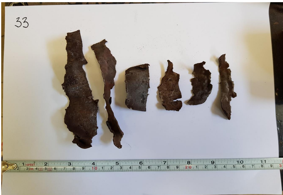
Slika 4-7. Krhotine cijevi broj 33 (63/45 \mu\text{m} , 1%)
