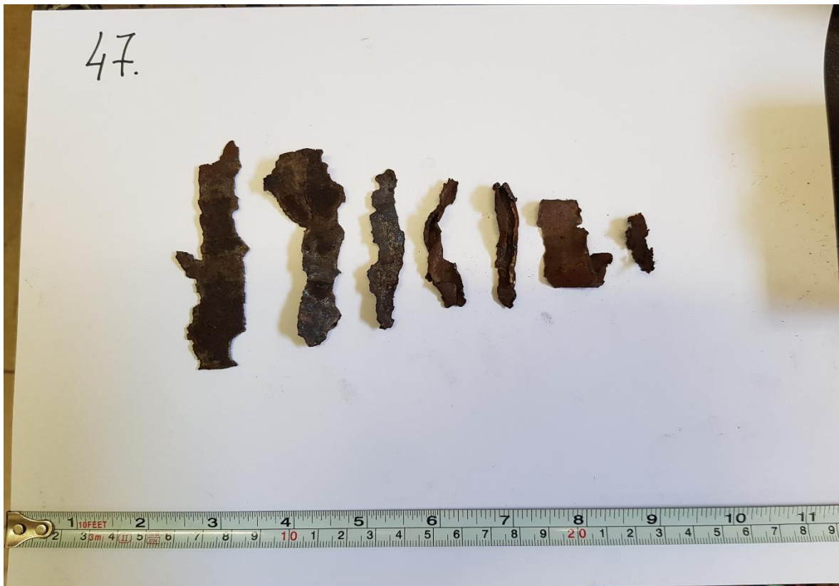
Slika 4-10. Krhotine cijevi broj 47 (63/45 \mu\text{m} , 4%)
