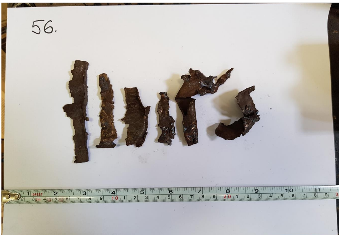
Slika 4-13. Krhotine cijevi broj 56 (90/75 \mu\text{m} , 1%)
