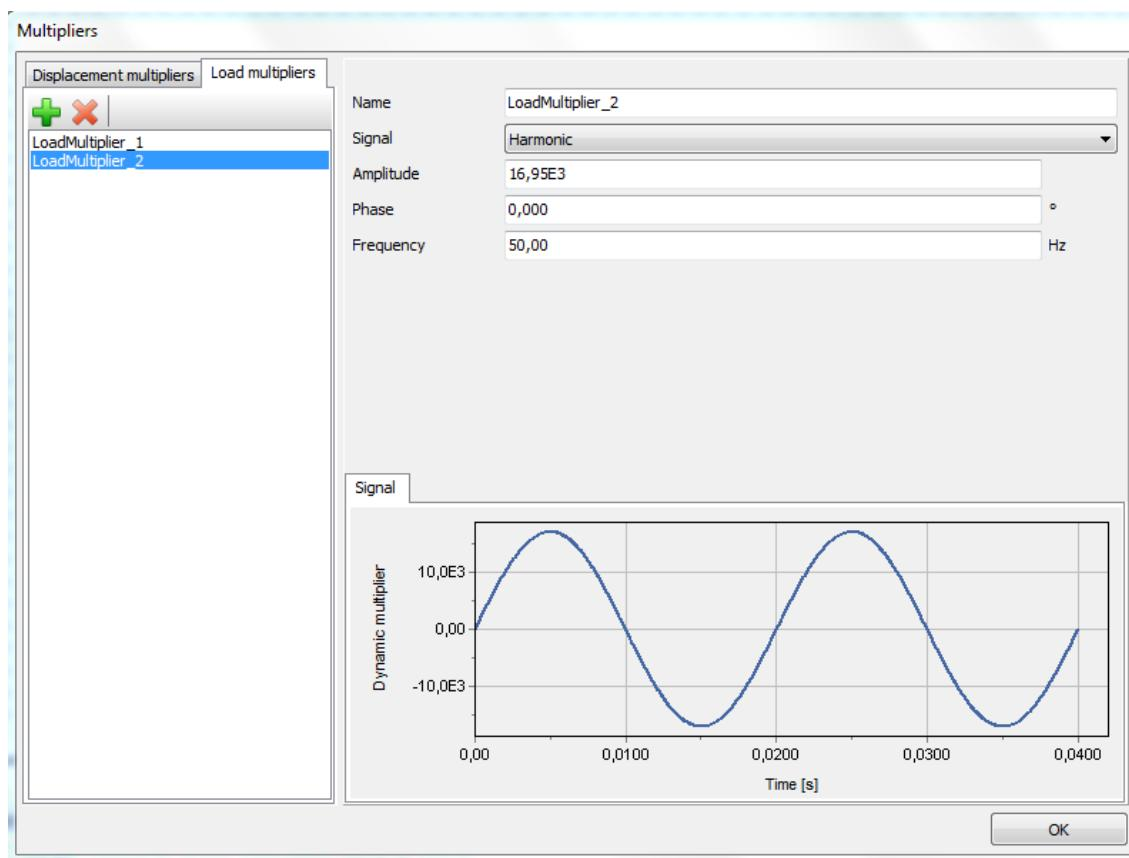
Slika 7-2 Simulacija dinamičkog opterećenja udarca bata pomoću harmonic multipliera
