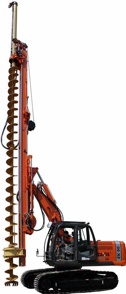
**Slika 3-6** Stroj za izradu pilota s kontinuiranim svrdлом Geax EK90 (Piling Equipment ltd., 2018)
