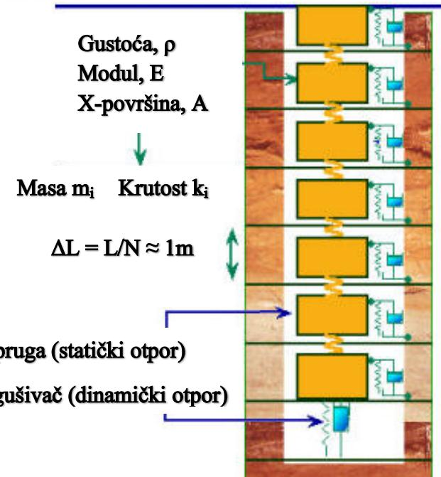
Slika 6-3 Model pilota i tla u sklopu analize valne jednadžbe (Pile Dynamics inc., 2019)
