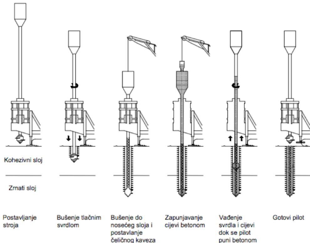
**Slika 3-3** Sistem izrade vijčanih, lijevanih, razmičućih pilota
