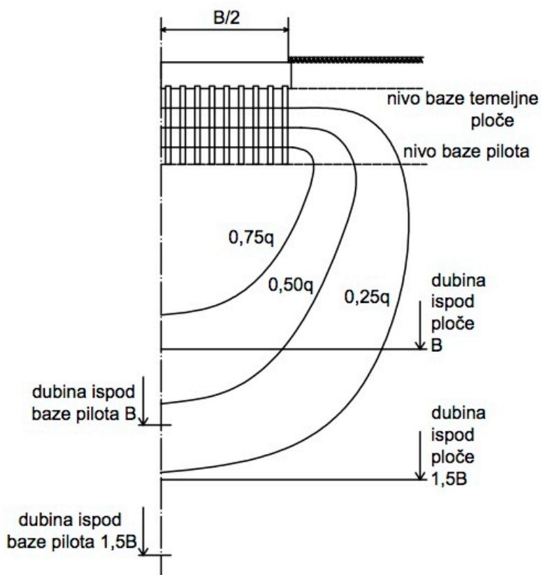
Slika 2-1 Vertikalne envelope naprezanja za temeljnu ploču poduprту pilotima
