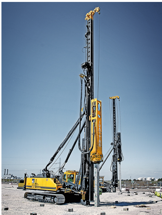
Slika 3-4 Junttan PM20LC stroj za zabijanje betonskih, drvenih i čeličnih pilota (Junttan Oy, 2019)
