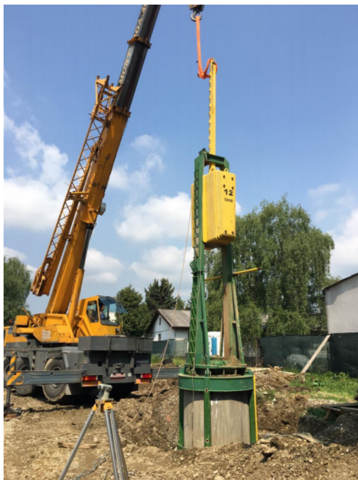
Slika 6-1 Ispitivanje probnog pilota promjera 150 cm (Matković, 2017)
