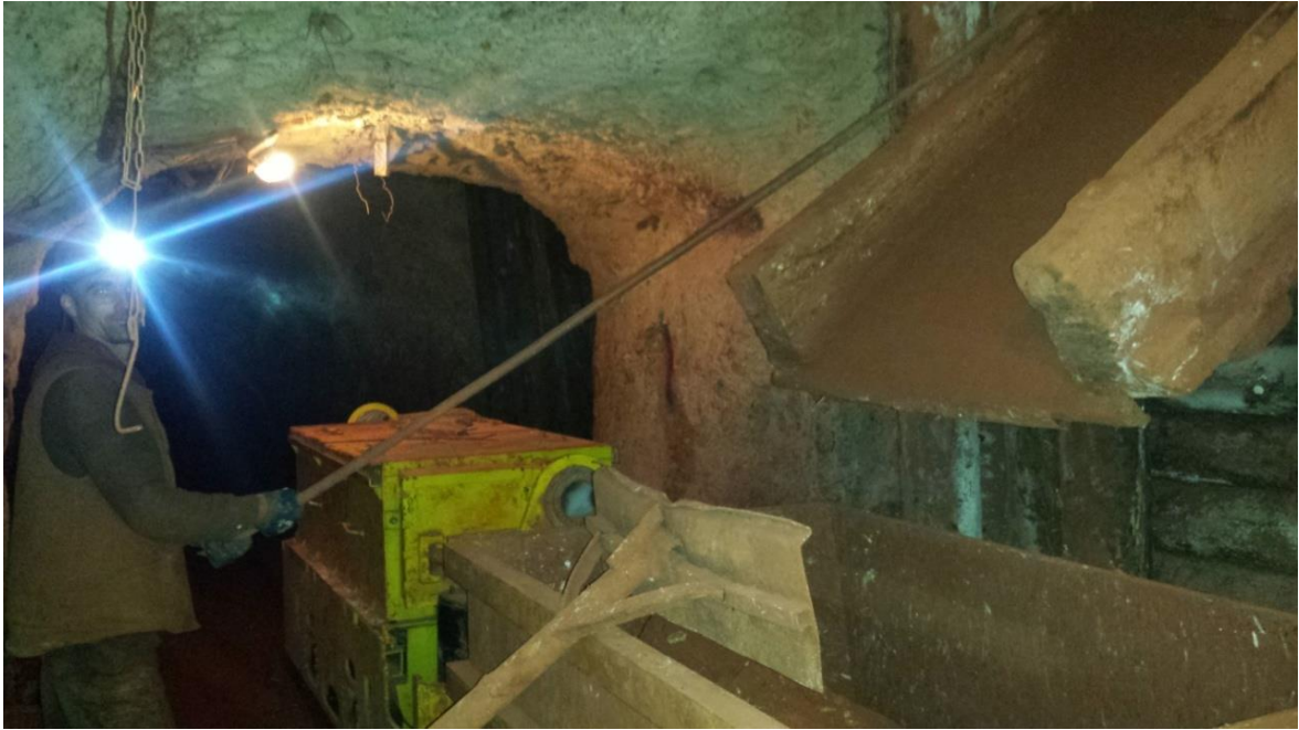
Slika 3-2. Utovar boksita u vagonete
