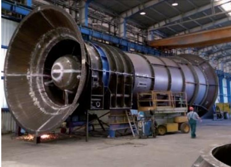
Slika 3 - 8. Aksijalni ventilator (TLT-turbo,2019)
