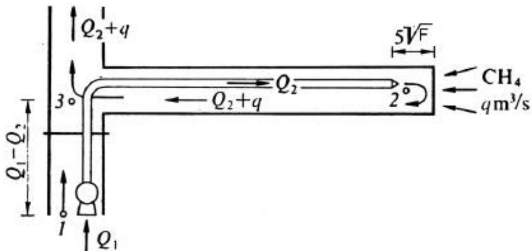
Slika 3 -11. Shema tlačne separacije (Vrkljan, 2016)
