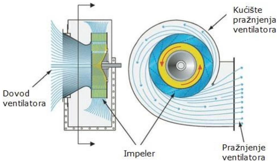
Slika 3 - 5. Skica radijalnog ventilatora (Vrkljan, 2016)
