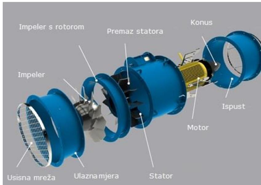
Slika 3 - 4. Dijelovi ventilatora (TLT-turbo,2019)
