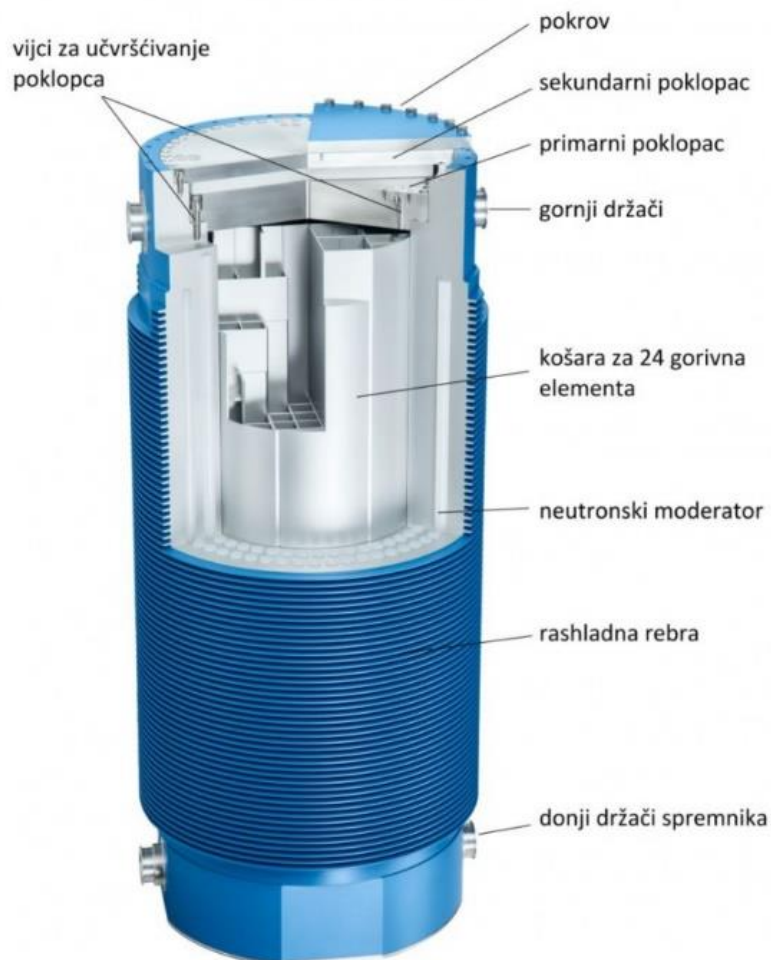
Slika 2 - 8. Spremnik za suho skladištenje ING-a (Zbrinjavanje radioaktivnog otpada, 2015)
