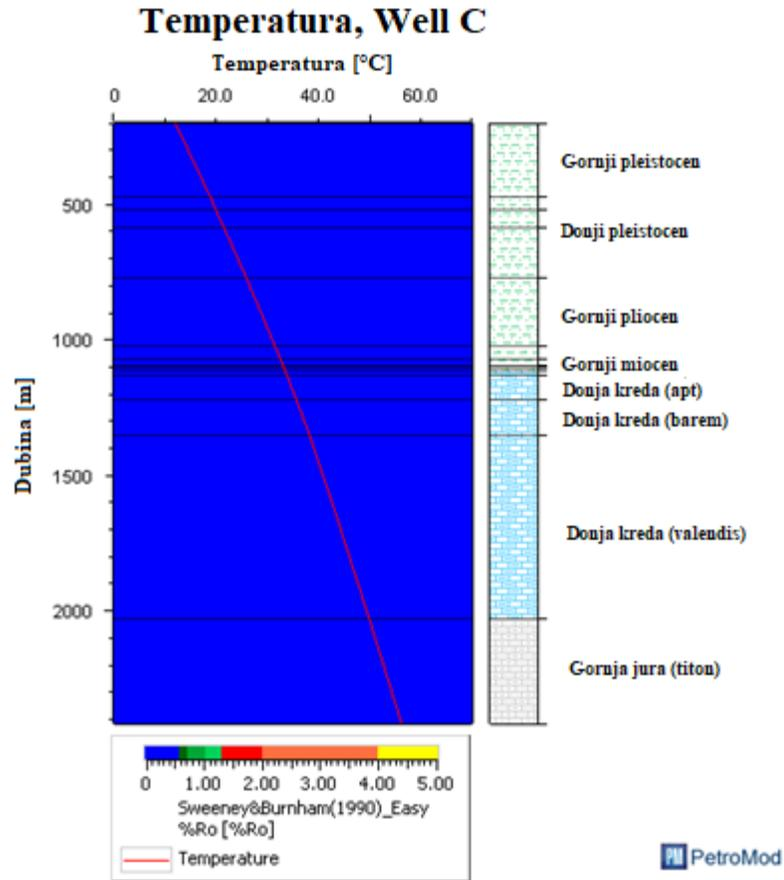
Slika 5.1 Vrijednosti temperature u bušotini Well C
