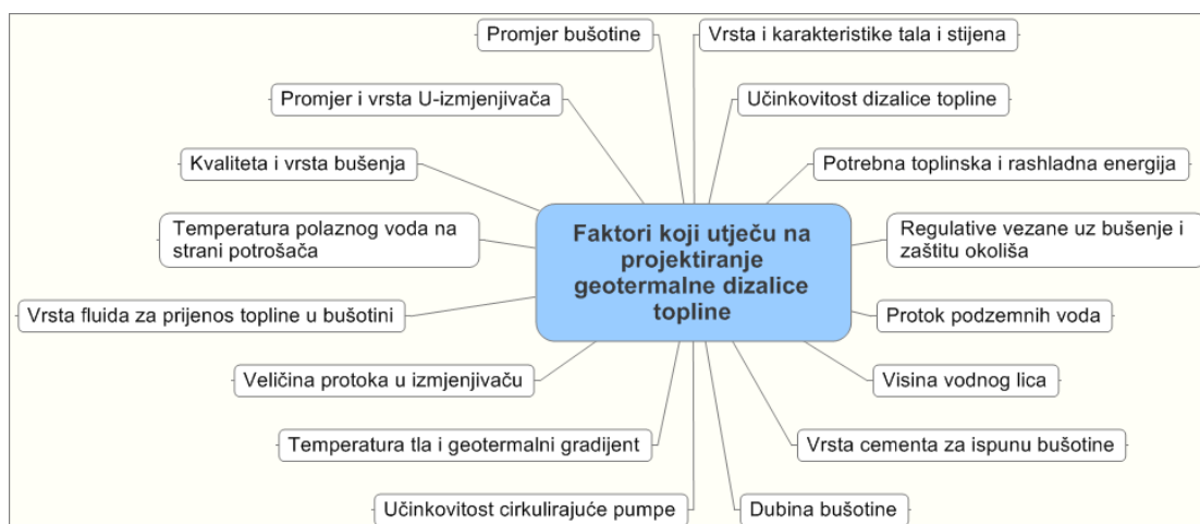
Slika 8-1. Faktori koji utječu na projektiranje i ekonomiku geotermalne dizalice topline
