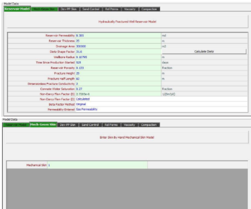
Slika 5-5. Podaci o ležištu, frakturi i skinu.
