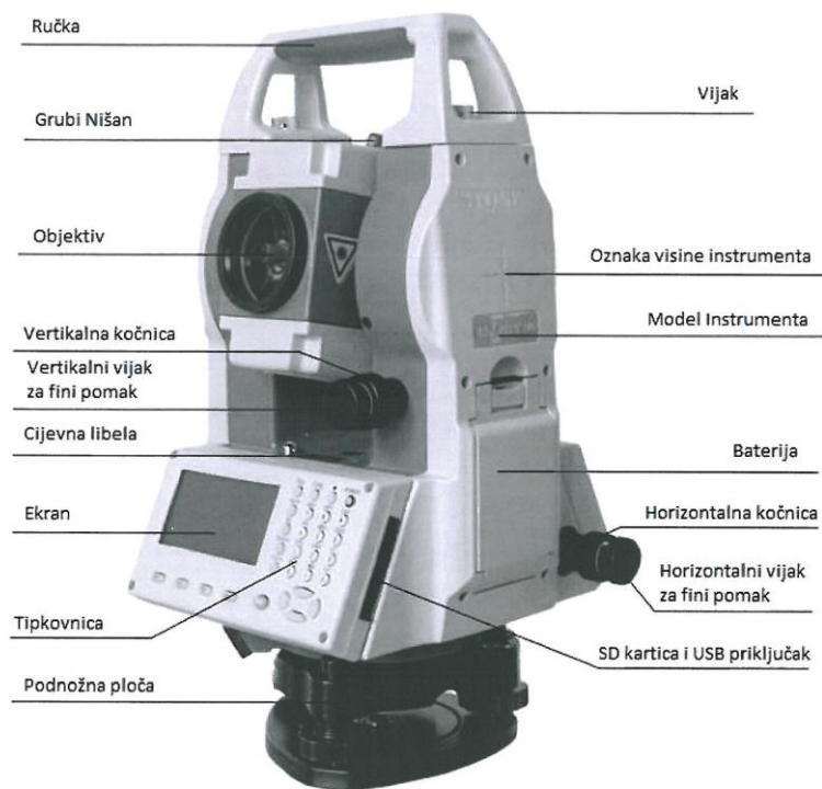
Slika 5-4. Totalna stanica PENTAX PTS-V3.
