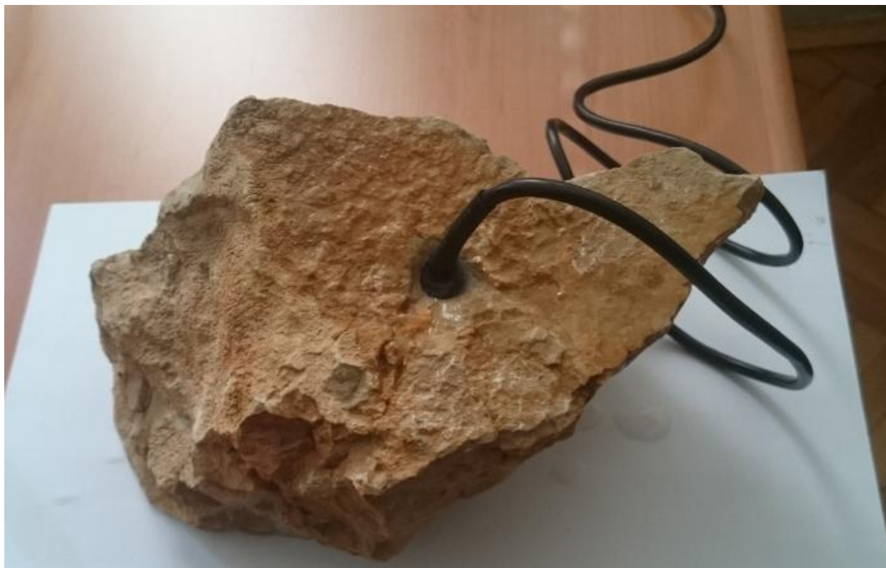
Slika 6-3: Mjerenje temperature na načelu otapanja leda do sobne temperature na uzorku br.2
