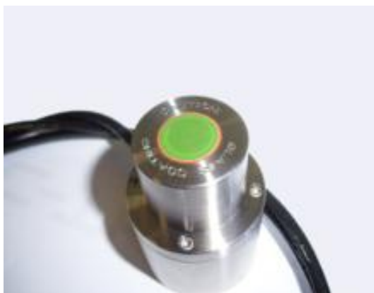
Slika 4-4: MTPS senzor. Preuzeto s
