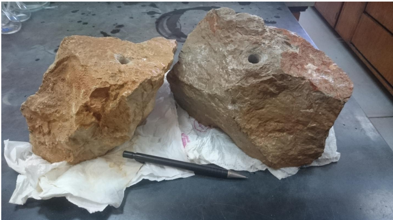
Slika 3-2: Uzorci vapnenca s probušenim rupama za termalni senzor
