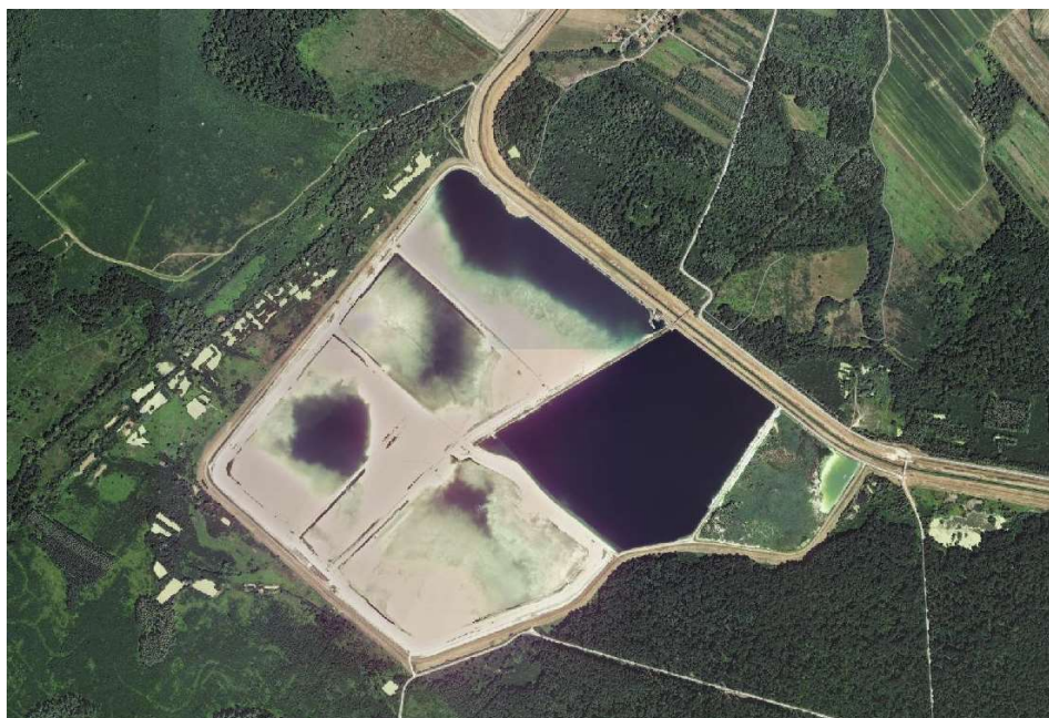
Slika 2-21 Lokacija za privremeno pohranjivanje fosfogipsa tvornice Petrokemija d.d.: 4 nasipima odvojene kazete odlagališta (DGU, 2018).
