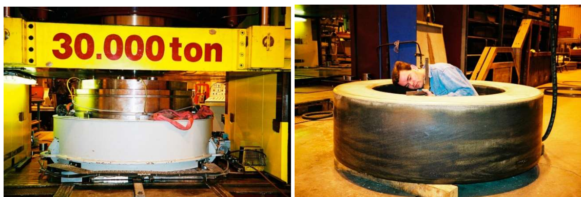
Slika 3-19 Priprema prstenova od bentonita kao materijala zapunjavanja prostora između spremnika i stijene (Bennett, 2012).
